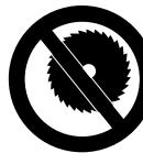
Nikada ne koristite cirkularne noževe za testerisanje, alate od tvrdog metala, alate za spasavanje, za sečenje drveta ili druge nazubljene alate – **opasnost od smrtonosnih povreda!** Nasuprot ravnomernom skidanju čestica kod korišćenja brusnih diskova za rezanje, zupci cirkularnog noža za testerisanje mogu da se zaglave u materijalu. To prouzrokuje agresivno ponašanje pri rezanju i može dovesti do nekontrolisanih, izuzetno opasnih reakcionih sila uređaja (odbijanje prema gore).
