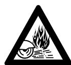
Kod rezanja čelika: zbog užarenih čestica materijala **opasnost od požara!**
