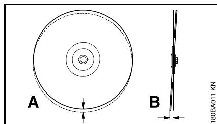
Preveliko bacanje (A) preopterećuje pojedinačne dijamantske segmente koji se pritom zagrevaju. To može dovesti do naprslina u jezgru lista ili do žarenja pojedinačnih segmenata.
