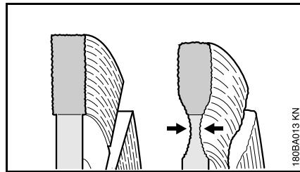
Kod rezanja kolovoznih pokrivača nemojte uranjati u noseći sloj (često tucanik) – brusno rezanje u tucaniku se prepoznaje po svetloj prašini – tada može nastati prekomerno trošenje jezgra – **opasnost od lomljenja!**
