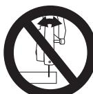
Brusni disk vodite pravo kroz rez, nemojte ga zaokretati bočno ili izlagati bočnim opterećenjima.
