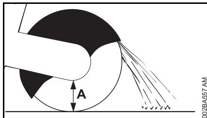
Postupak zavisi od spoljnog prečnika cevi i od maksimalno moguće rezne dubine brusnog diska (A).
