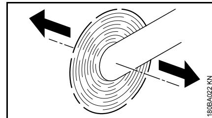
Kada se brusni sekač sa rotirajućim brusnim diskom pokreće u smeru strelice, javlja se sila koja pokušava da prevrne uređaj.
