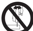
Brusni disk vodite pravo kroz rez, nemojte ga zaokretati bočno ili izlagati bočnim opterećenjima.
