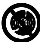
Češće kontrolišite brusni disk – odmah ga zamenite kod pojave naprslina, iskrivljenosti ili drugih oštećenja (na primer, pregrevanja) – zbog lomljenja
