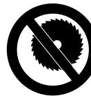
Nikada ne koristite cirkularne noževe za testerisanje, alate od tvrdog metala, alate za spašavanje, za sečenje drveta ili druge nazubljene alate – **opasnost od smrtonosnih povreda!** Nasuprot ravnomernom skidanju čestica kod korišćenja brusnih diskova za rezanje, zupci cirkularnog noža za testerisanje mogu da se zaglave u materijalu. To prouzrokuje agresivno ponašanje pri rezanju i može dovesti do nekontrolisanih, izuzetno opasnih reakcionih sila uređaja (odbijanje prema gore).
