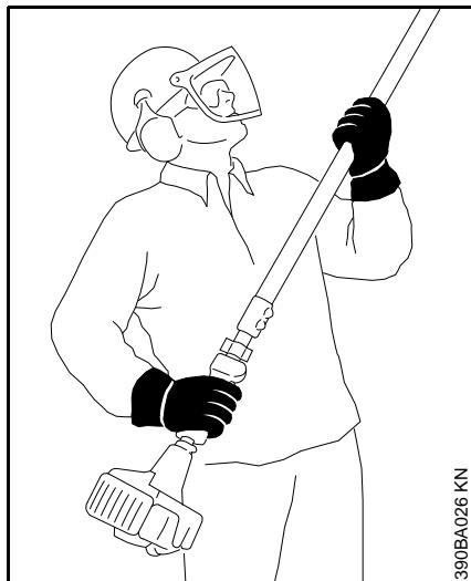
Radi bezbednog vođenja motorni uređaj držite uvek čvrsto **obema rukama** – desna ruka na komandnoj ručici, leva ruka na telu uređaja – takođe i kod levorukih. Komandnu ručicu i telo uređaja čvrsto obuhvatite palčevima.
